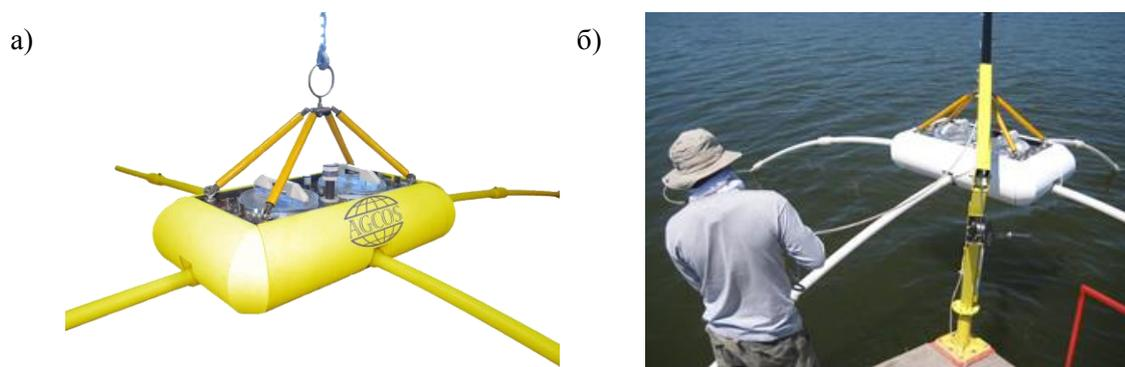
Рис. 2. Морские донные EM станции для работ в транзитных зонах; а) 2-х канальная система SMMT; б) запуск системы SMMT с палубы катамарана.
