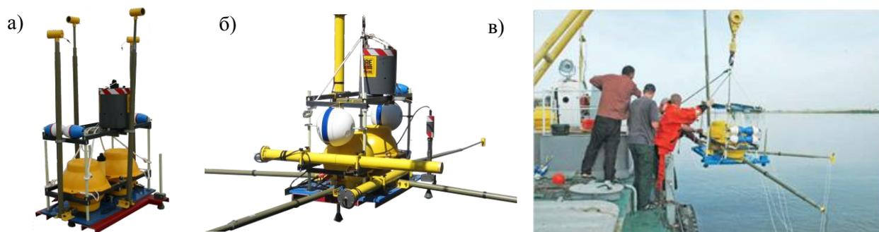
Рис. 3. Морские донные EM станции для работ на шельфе; а) 2-канальная 2AUSS-07A; б) 5-канальная 5AUSS-07A; в) запуск малоглубинной донной станции в Каспийском море сотрудниками компании Норд-Вест, Москва.
