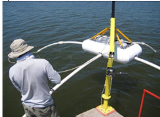
**Рисунок 2** Морские донные EM станции для работ в транзитных зонах; (а) 2-х канальная система SMMT; (б) Запуск системы SMMT с палубы катамарана
