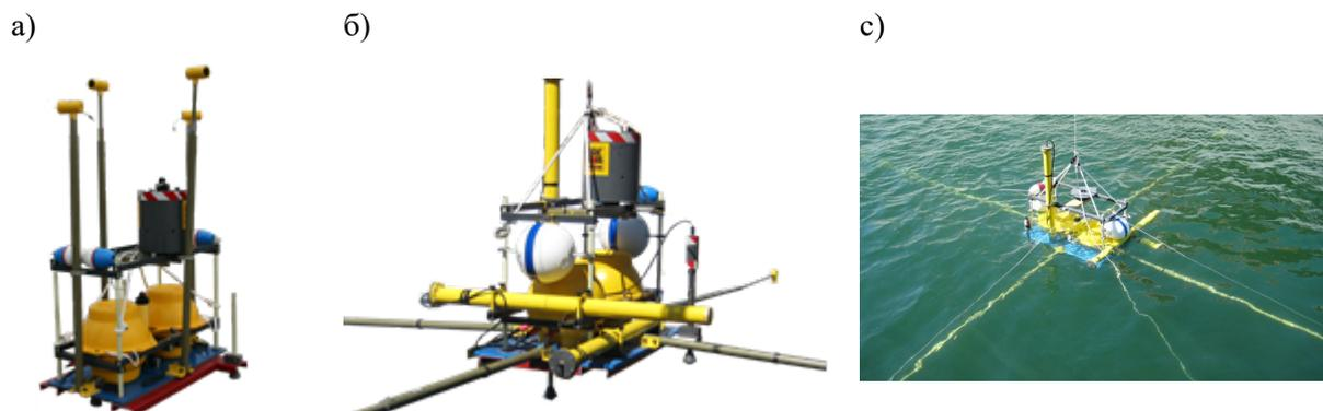
**Рисунок 3** Морские донные EM станции для работ на шельфе; (а) 2-канальная 2AUSS-07А; (б) 5-канальная 5AUSS-07А; (в) Подъем малоглубинной донной станции в Черном море
